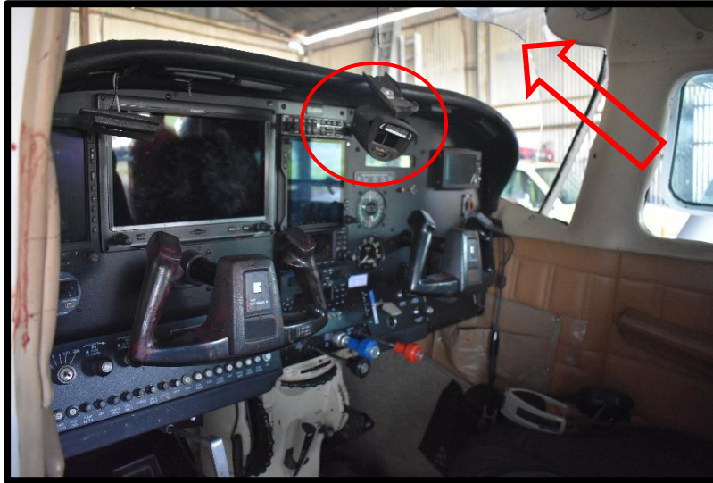
Fotografía No. 3 Windshield quebrado, daños en la base de la brújula.
